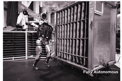
ボストン・ダイナミクス社が手掛ける人型ロボット「アトラス」。自動車の製造現場で部品を仕分けする姿が映し出されている
